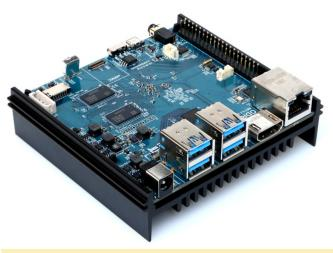
Figure 1 - The New ODROID-N2 Board
