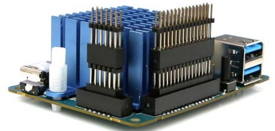
Los extensores de cabezales se pueden apilar para que los pines GPIO sean más accesibles
