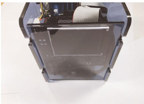
Figura 13 - Coloca la pieza delantera en la parte frontal (C)
