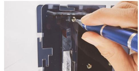
Figura 8 - Atornilla la placa CloudShell-2 a las piezas izquierda y derecha (O)
