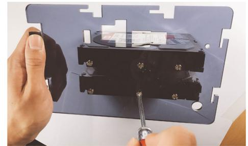
Figura 6 - Atornilla las piezas izquierda y derecha a los discos duros (A + B + P)
