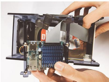
Figura 12 - Conecta el cable plano GPIO y el cable USB 3.0 entre el ODRROID-XU4 y la placa CloudShell-2 (F + H)
