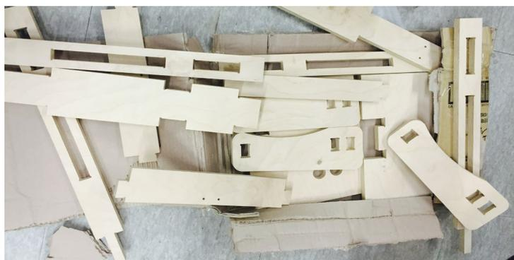
Piezas de madera del mecanizado CNC
