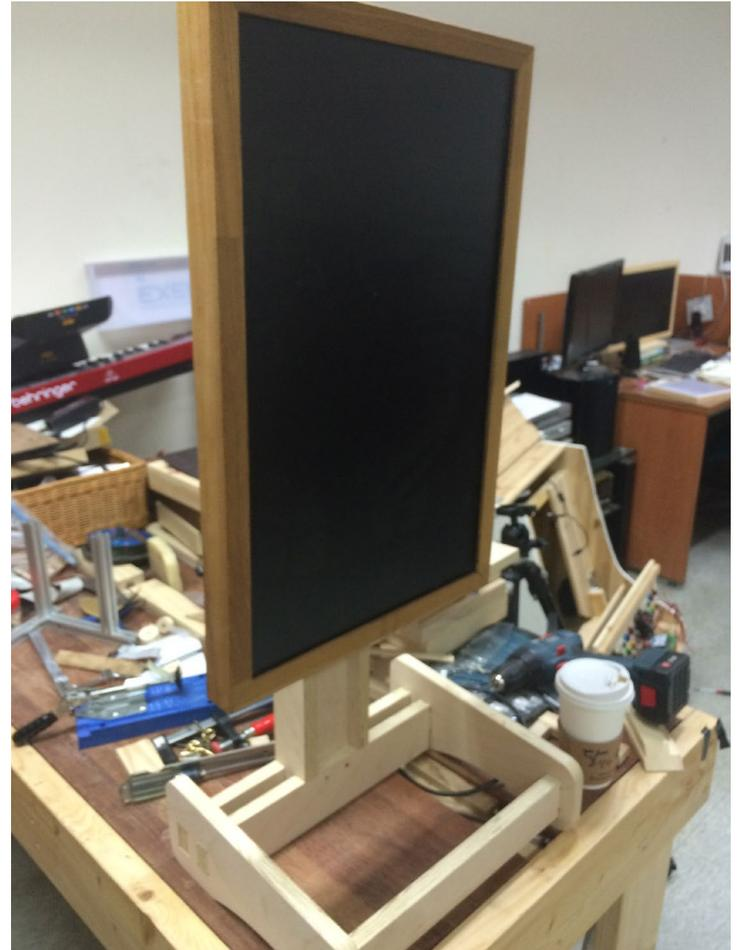
Montaje de la pantalla en la estructura principal
