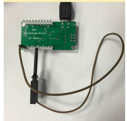
bar el uso del dispositivo. Utiliza el cable proporcionado como se muestra en la Figura 2 para conectar el pin del canal 1 y el pin AWG. Luego, conecta el cable USB suministrado al MultiScope y a la placa ODROID.
