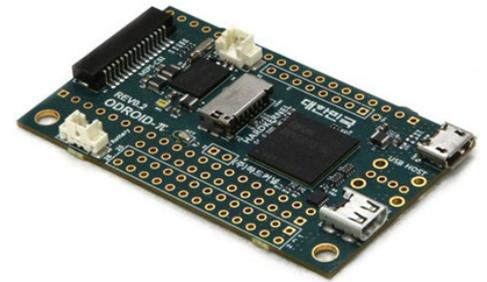
Figura 2 – Primer plano del ODROID-W
