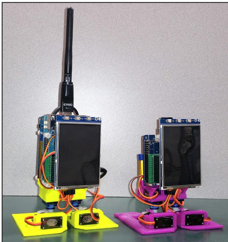
**El OWEN montado con 2 configuraciones distintas: conectado por cable y de forma inalámbrica.**
