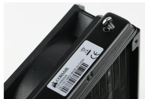
Figura 3 - El tornillo autorroscante y el orificio para rellenar el refrigerante
