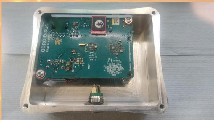
**Figura 6 - ODRROID-XU4 dentro del área de refrigeración de la parte superior**
