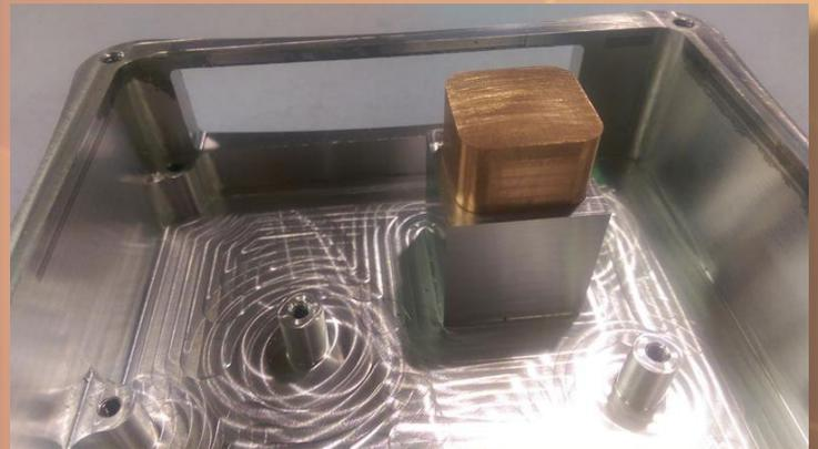
Figura 4 - El núcleo de cobre unido al interior de la caja para la refrigeración pasiva
